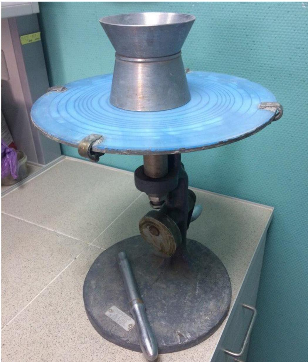
Рис. 4 Встряхивающий столик ЛВС и форма-конус. Метод определения подвижности растворной смеси по расплыву конуса, ГОСТ 310.4.
