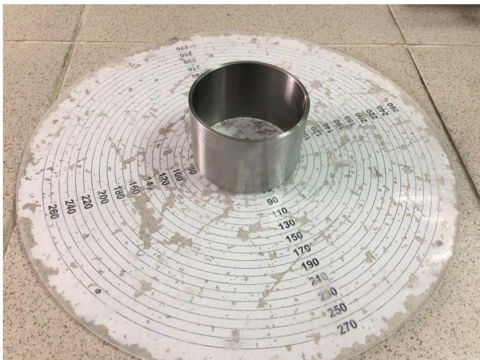
Рис. 1 Кольцо из нержавеющей металла. Метод определения подвижности растворной смеси по расплыву кольца, ГОСТ 31356.
