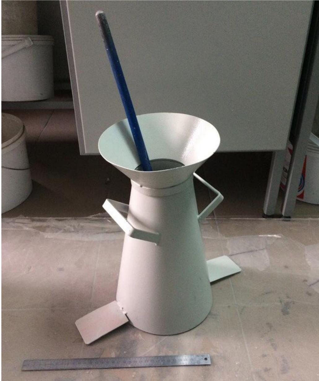
Рис. 3 Конус (нормальный). Метод определения подвижности (удобоукладываемости) бетонной смеси по осадке конуса, ГОСТ 10181.
