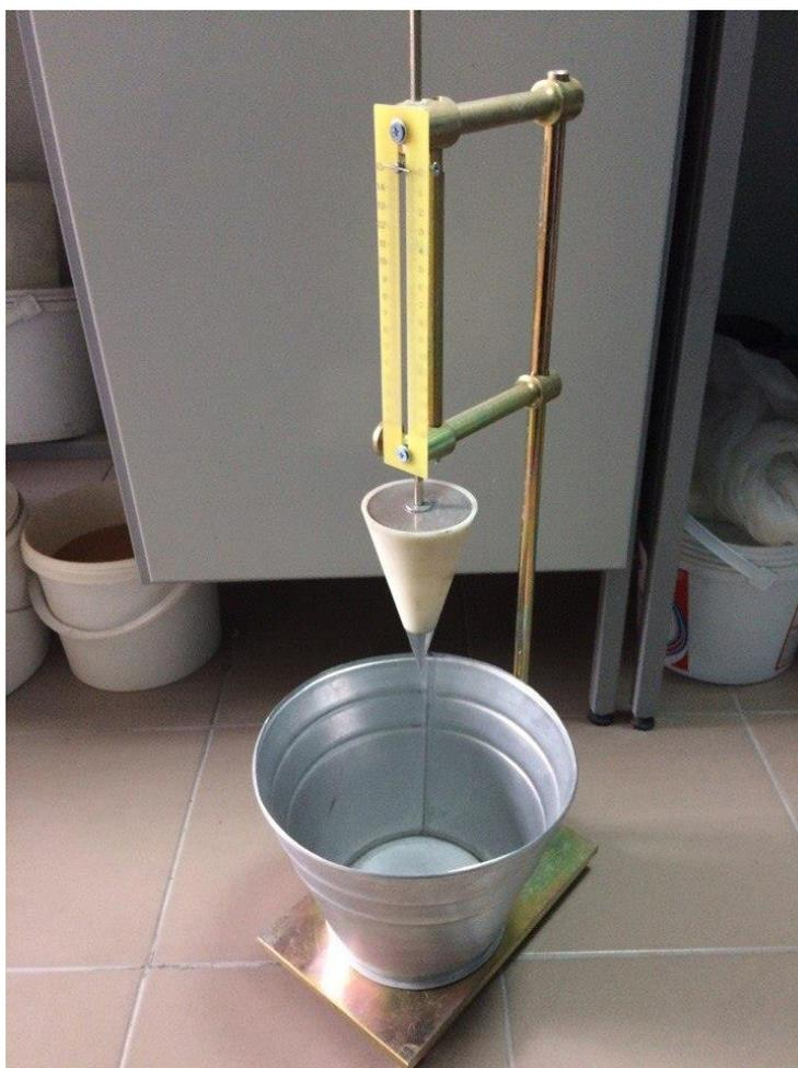
Рис. 2 Прибор ПГР. Метод определения подвижности растворной смеси по погружению конуса, ГОСТ 5802.
