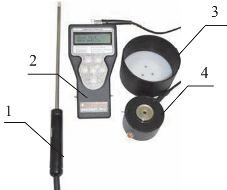
1 – зондовый преобразователь (датчик); 2 – электронный блок прибора; 3 – датчик для насыпных материалов; 4 – датчик поверхностного типа для твердых стройматериалов.
